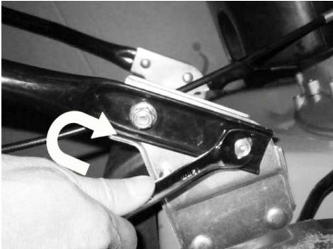
Paigaldage alumised juhtraad seadme korpuse külge sobiva mutrivõtme abil. (Joonis 1).
