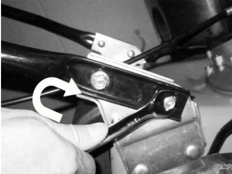
Zamontować dolny uchwyt na urządzeniu za pomocą śrub i nakrętkę mocujących przeznaczonych do danego uchwyty, jak na zdjęciu poniżej.
