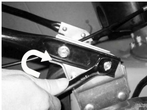
Fissare le barre inferiori dell'impugnatura al corpo della macchina con una chiave idonea.
