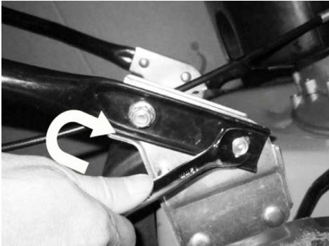
Fixe o guiador na alça inferior da chassi com uma chave de ferramenta adequada.
