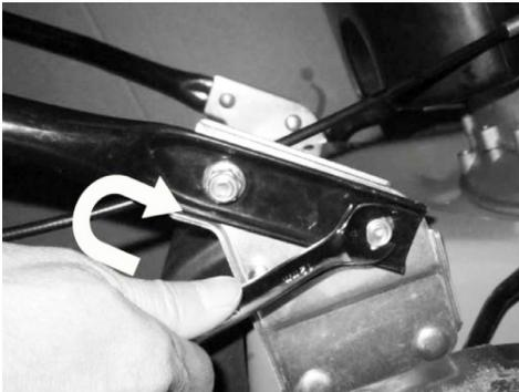
Зафиксируйте нижние рамки в корпусе при помощи ключа.
