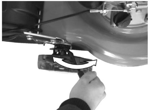
Aplique pressão para fora para desengatar a alavanca. Mova a alavanca para a frente ou para trás para ajustar a altura do corte.
