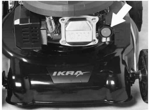
**ЗАПУСК ДВИГАТЕЛЯ:** Нажмите желтеет Праймер с силой 3 раза. Если двигатель отключается из-за недостатка топлива, наполните резервуар и нажмите праймер 3 раза. В основном, предпусковая подготовка не важна для запуска прогретого двигателя.
