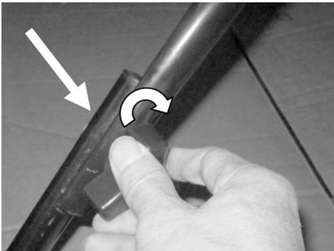
Fixez la partie supérieure de la poignée avec les vis à poignée étoile sur les parties inférieures de la poignée. (Fig. 2)
