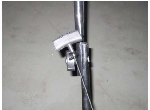
Introduza a corda de arranque do motor na fixação apropriada no guiador.
