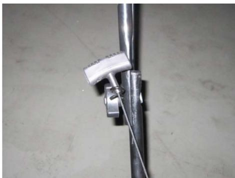
Inserire la fune per il contraccollo della leva dello starter sulla guida di supporto della fune.
