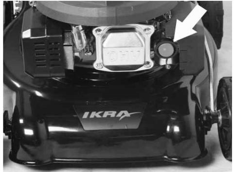
Ao iniciar um motor novo pela primeira vez, pressione com firmeza a bomba de combustível (Primer) 5 vezes. Para próximas utilizações pressione a bomba de combustível (Primer) 3 vezes.
