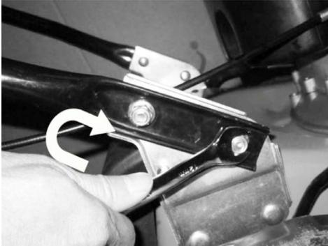
Befestigen Sie die unteren Teile der Handgriffe mit einem geeigneten Schraubenschlüssel am Maschinengehäuse.
