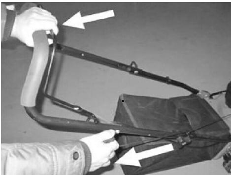
**La lama è in funzione non appena il motore è avviato. Mentre la macchina è in funzione, mantenere la leva di controllo del freno in posizione di lavoro. Il motore si arresterà non appena si rilascia la leva di controllo del freno.**
