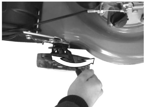
Applicare una pressione verso l'esterno per staccare la leva dal telaio, spostare la leva avanti o indietro per regolare l'altezza.
