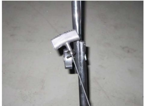
Stecken Sie das Seil des Aufwickelstartergriffs in die Seilführung.
