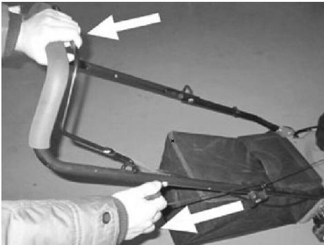
A lâmina está em movimento logo que o motor esteja em ligado. Mantenha a alça do freio da lâmina em posição de funcionamento enquanto a máquina esta a trabalhar. O motor irá parar assim que solte a alça do freio da lâmina.
