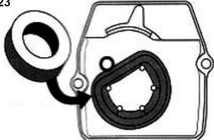
3. Waschen Sie den Filter in Wasser und Spülmittel (Abb. 24). Spülen Sie den Filter sorgfältig mit klarem Wasser. Drücken Sie überschüssiges Wasser heraus. Lassen Sie den Filter vollständig trocknen.
