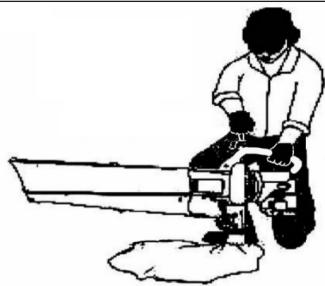
**REMARQUE :** Au cas où le moteur serait « noyé » lorsque vous tentez de le démarrer, placez le clapet de démarrage en position C. Placez le levier de vitesse en position « Rapide » (III. 11). Tirez par à-coups sur le cordon de démarrage : le moteur devrait démarrer au bout de 3 à 8 essais.
