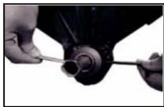
Entfernen Sie den oberen Rückhalteflansch.
