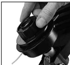
Відріжте струну приблизно на 17 см, щоб уникнути надмірного навантаження двигуна під час запуску і прогрівання.
