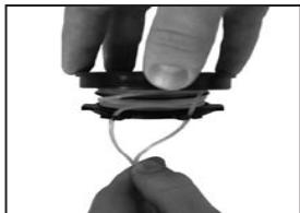
Провести каждый конец веревки через отверстия на противоположных сторонах катушки.
