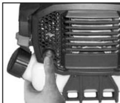
4 Tirare 2 o 3 volte la fune del dispositivo d'avviamento. Per avviare il motore occorre tirare con uno strappo deciso e ad intervalli regolari.
