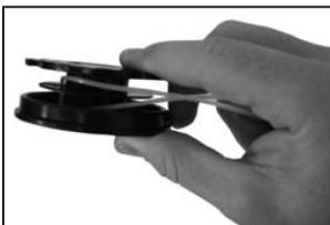
Asegúrese de que el hilo esté siempre tenso y que cada mitad de la cuerda se queda en la cubierta del carrete separado de forma apropiada.
