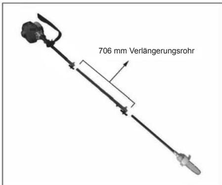
Чтобы достичь высокого положения, можете добавить удлинительный вал между основным телом и добавленным приспособлением.
