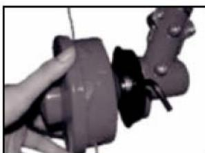
Veillez à ce que la bobine de fil soit placée correctement dans le boîtier, que le ressort se trouve sous la bobine et que les extrémités du fil soient bien guidées vers l'extérieur par les deux œillets.
