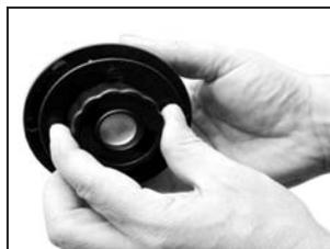
Удалить катушку и пружину со шпинделя.
