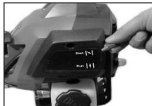
3 Drücken Sie die Benzinpumpe 6 mal.
