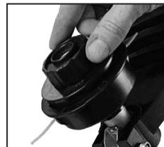
Corta el cordón a unos 17 cm para evitar una carga excesiva al motor durante el arranque y la fase de calentamiento.
