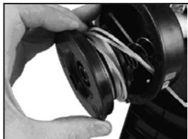
Поставте котушку в кожух, одночасно витягаючи кінці струни через отвори. Перевірте чи правильно поставлена пружина відносно котушки і кожуха.
