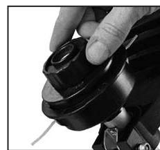
10. Raccourcissez le fil sur 17 cm environ, afin de moins charger le moteur dans la phase de démarrage et d'échauffement.
