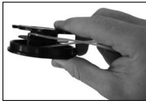
Wickeln Sie beide Fadenhälften gleichzeitig auf die Spule auf. Die Wickelrichtung ist in die Spule eingeprägt: „Wind Cord“. Achten Sie auf feste Spannung und darauf, dass sich die beiden Fadenhälften im jeweiligen separaten Spulengehäuse befindet. Wickeln Sie den Faden auf, bis jeweils 15 cm Fadenlänge verbleiben
