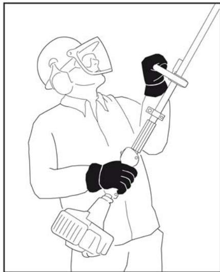
Posizionare la propria mano sinistra sull'impugnatura anteriore e quella destra sull'impugnatura posteriore della leva dell'acceleratore. Questo vale anche per i mancini. Mantenere le mani sempre in questa posizione per mantenere sempre il controllo sull'attrezzo.
