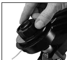
Отрезать веревку приблизительно на 17 см, чтобы избежать чрезмерной нагрузки двигателя во время запуска и прогрева.
