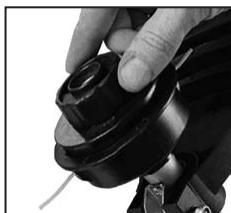
Accorciare il cordoncino del filo a circa 17 cm per non sovraccaricare il motore in fase di avviamento e riscaldamento.
