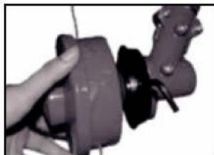
Проверить правильно ли поставлена катушка для веревки в кожух катушки, пружина поставлена под катушкой и концы веревки проведены через обоих глазков.
