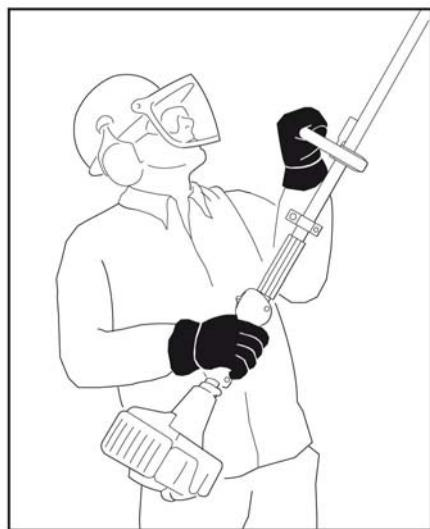
Поставете лявата си ръка на предната ръкохватка, а дясната ръка върху задната ръкохватка и скобата на газта. Левичарите трябва също да следват тези указания. Дръжте ръцете си в това положение, за да можете да държите верижния трион под контрол през цялото време.
