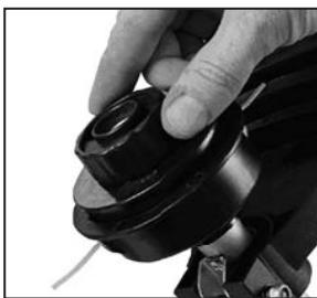
Zkraťte strunu na asi 17 cm, aby se zajistilo nízké zatížení motoru v průběhu startovací a zahřívací fáze.
