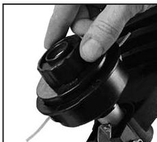
Kürzen Sie die Fadenschnur auf ca. 17 cm, um den Motor in der Start- und Aufwärmphase geringer zu belasten.
