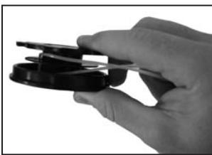
5. Enroulez les deux moitiés du fil simultanément sur la bobine. Le sens d'enroulement est indiqué sur la bobine : « Wind Cord ». Veillez à ce que le fil soit bien tendu et à ce que les deux moitiés de fil se trouvent chacune dans un boîtier de bobine séparé. Enroulez le fil jusqu'à avoir respectivement un reste de fil d'une longueur de 15 cm.
