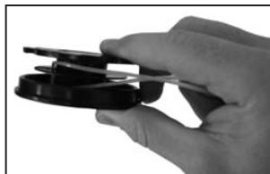
Намотать обе половины веревки одновременно вокруг катушки. Направление навивки указано на катушке: „Wind Cord“ (наматывание веревки). Убедитесь, что веревка всегда натянута и что каждая половина веревки стоит в соответствующем отдельном кожухе катушки. Намотать веревку, пока останутся 15 см веревки с каждого конца
