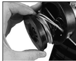
8. Mettez la bobine dans le boîtier tandis que vous faites passer les extrémités du fil par l'oeillet. Assurez-vous que le ressort est placé au bon endroit par rapport à la bobine et au boîtier.
