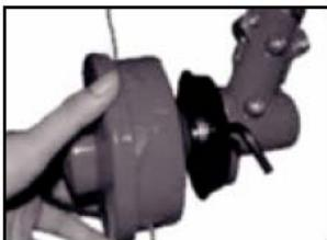
Por favor, asegúrese de que el eje esté correctamente asentado en su carcasa, el muelle se encuentra bajo la línea del eje, y los extremos del eje están dirigidos al exterior a través de los ojales.
