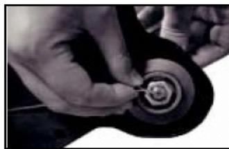
Retire el pasador del extremo del eje de accionamiento.
