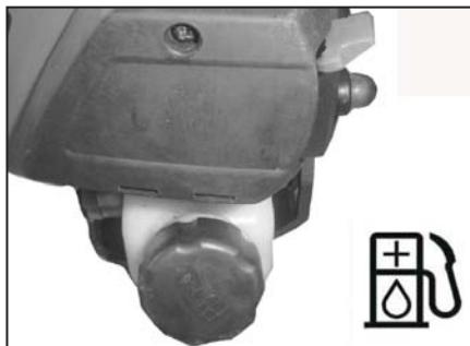
Перед заправкой почистить крышку заливной горловины и вокруг нее для избегания попадания грязи в резервуар.
