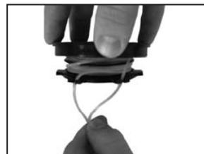
6. Guidez les extrémités respectives du fil à travers les ouvertures au côté opposé de la bobine.
