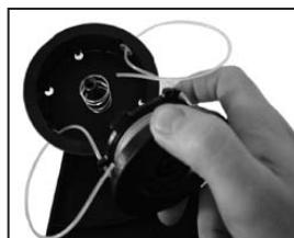
7. Guidez le ressort sur la broche et enfilez les extrémités du fil par les oeillets du boîtier.
