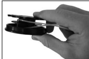
Намотайте обидві половини струни одночасно навколо катушки. Напрямок навивки зазначений на катушці: „Wind Cord” (намотування струни). Переконайтесь, що струна завжди натягнута і, що кожна половина струни знаходитьсь у відповідному окремому кожусі катушки. Намотуйте струну до того моменту, поки залишиться 15 см струни з кожного кінця.
