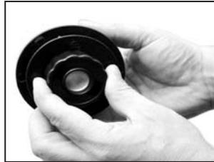
Зніміть катушку і пружину зі шпинделем.
