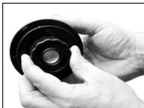
Z vřetena odstraňte cívku se strunou a pružinu. Odstraňte zbytky vyžínací struny.
