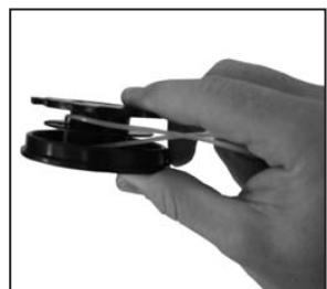
Obě půlky struny naviňte na cívku současně. Směr navíjení je vyražený na cívce: „Wind Cord“. Dbejte na pevné navinutí a na to, aby se obě půlky struny nacházely ve své samostatné drážce cívky. Strunu naviňte tak, aby na koncích zůstalo po 15 cm volné struny.
