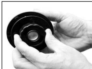
Entfernen Sie die Fadenspule und Feder von der Spindel. Entfernen Sie den verbleibenden Schneidfaden.
