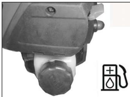
Bevor Sie den Tank befüllen, säubern Sie den Bereich um dem Tankdeckel, damit kein Schmutz in den Tank fällt.
