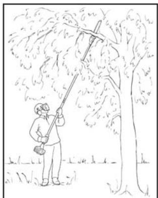
L'arbre d'entraînement doit être tenu à un angle de 60° au maximum !
