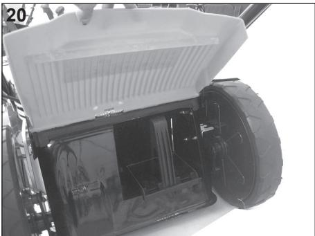
2. Premere il lato inferiore dell'impugnatura per rilasciare e rimuovere l'accessorio per mulching (Fig. 20).
