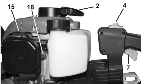
1. Drücken Sie mehrmals den Knopf der Einspritzpumpe, bis der Kraftstoff in die Pumpe gelangt.
