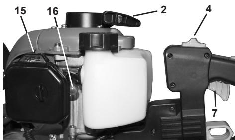
1. Coloque el interruptor de encendido/apagado (4) en la posición **Start**.
