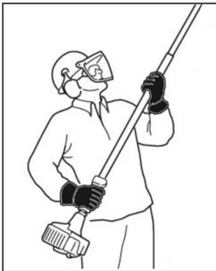
Posizionare la propria mano sinistra sull'impugnatura anteriore e quella destra sull'impugnatura posteriore della leva dell'acceleratore. Questo vale anche per i mancini. Mantenere le mani sempre in questa posizione per mantenere sempre il controllo sull'attrezzo.
