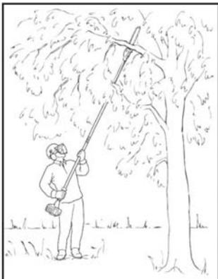
L'arbre d'entraînement doit être tenu à un angle de 60° au maximum !
