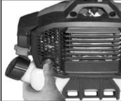
4 Empuje la cuerda de arranque 2-3 veces, para iniciar el motor, de manera uniforme, rápidamente tirar de la cuerda.
