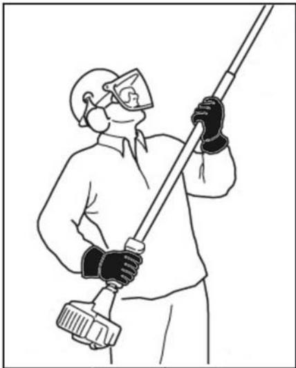
Placer din venstre hånd på det forreste greb og din højre hånd på det bageste greb på gasreguleringen. Det gælder også for venstrehådede. Hold altid dine hænder i denne position, så du altid har kontrol over din sav.
