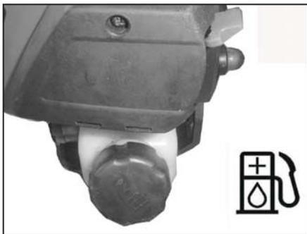
Vooraleer u de tank vult, reinig de ruimte omheen de tankdop, zodat geen vuil in de tank komt.
