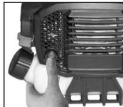
4 Ziehen Sie das Starterseil 2 bis 3 mal. Um den Motor zu starten müssen Sie es schnell und regelmäßig ziehen.
