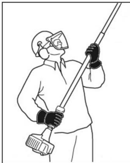
Coloque su mano izquierda en el asa frontal y maneje la máquina con la mano derecha colocada sobre el área adherente trasera y el gatillo del acelerador. Las personas
