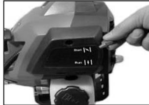
3 Drücken Sie die Benzinpumpe 6 mal.
