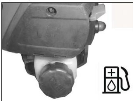
Avant de remplir le réservoir, nettoyez la zone qui entoure le bouchon du réservoir de manière à ce qu'aucune impureté ne puisse tomber dans le réservoir.
