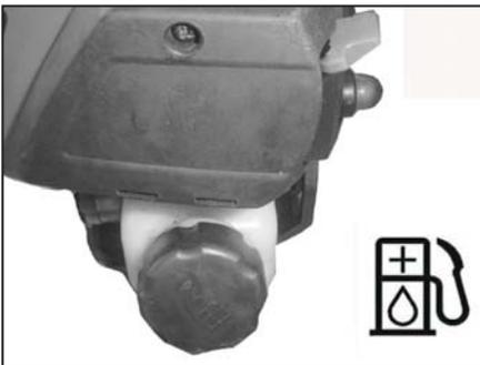
Bevor Sie den Tank befüllen, säubern Sie den Bereich um dem Tankdeckel, damit kein Schmutz in den Tank fällt.
