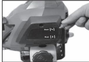
3 Drücken Sie die Benzinpumpe 6 mal.
