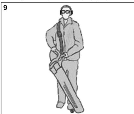
6. În poziția de lucru (Fig. 9) reglați-vă lungimea curelei la înălțimea dumneavoastră.
