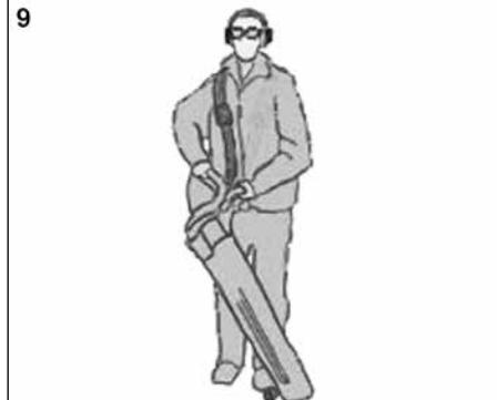
6. Stellen Sie den Gurt in Arbeitsposition stehend (Abb. 9) auf die Körpergröße des Bedieners ein.
