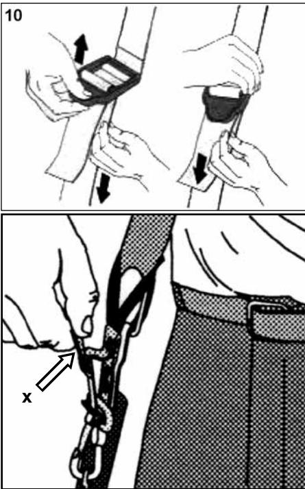
**ACHTUNG:** Dieser Tragegurt hat eine Sicherheitsvorrichtung, damit im Notfall der Gurt sofort von dem Gerät getrennt werden kann. Ziehen Sie dazu kräftig an der roten Zuglasche (x) des Gurtes. Der Gurt ist damit sofort von der Haltevorrichtung getrennt.
