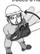
19. Protection contre le recul. Le recul est le mouvement vers le haut de la barre guide qui survient quand la chaîne de la scie sur le nez de la barre guide entre en contact avec un objet. Le recul peut provoquer une dangereuse perte de contrôle de la tronçonneuse.
