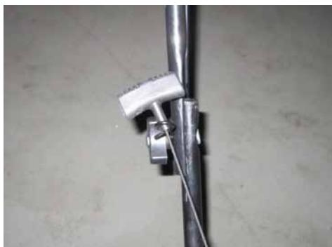
Inserire la fune per il contraccolpo della leva dello starter sulla guida di supporto della fune.
