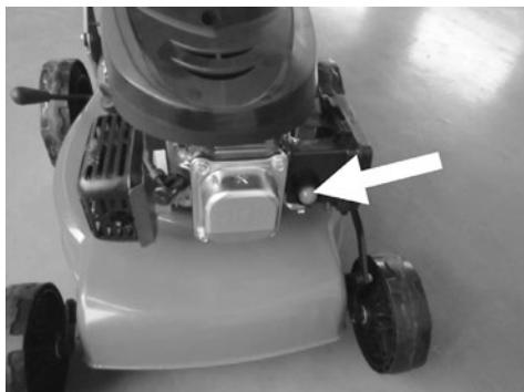
**ЗАПУСК ДВИГАТЕЛЯ:** Нажмите жалтеет Праймер с силой 3 раза. Если двигатель отключается из-за недостатка топлива, наполните резервуар и нажмите праймер 3 раза. В основном, предпусковая подготовка не важна для запуска прогретого двигателя.
