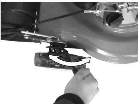
Taikykite išorinį spaudimą ir iš stovo pašalinkite svirtį. Reguliuodami aukštį, svirtį perkelkite į priekį arba atgal.
