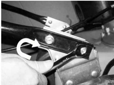
Paigalda alumised juhtrauad seadme korpusse külge sobiva mutrivõtme abil. (Joonis 1).
