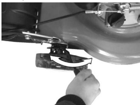
Нажмите с усилием от себя, чтобы открепить рычаг, затем передвигните рычаг вперед или назад, чтобы отрегулировать высоту.
