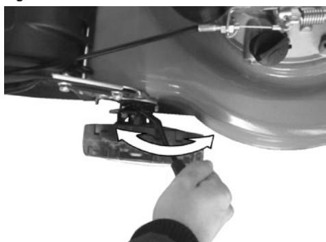
Relâchez le levier en appuyant sur le cadre et déplacez-le d'avant en arrière, pour régler la hauteur (Fig. 8).
