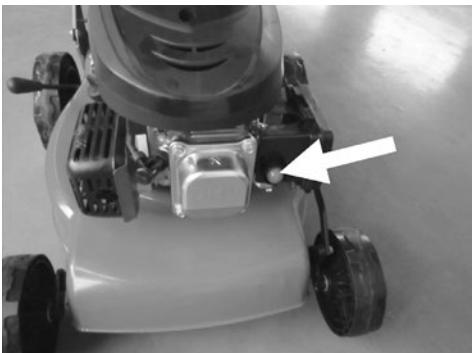
Uue mootori esmakordsel käivitamisel vajutage kollane käspumpa (Joonis 1) jöäliselt viis korda. Käivitades mootorit edaspidi vajutage käspumpa kolm korda.
