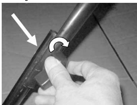
Befestigen Sie das obere Teil des Handgriffs mit den Viergriegelungsknöpfen in den unteren Teilen des Handgriffs.
