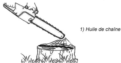
L'écoulement de l'huile de chaîne peut être modifié en introduisant un tournevis en bas du côté de l'embrayage. Ajustez en fonction de vos conditions de travail.
