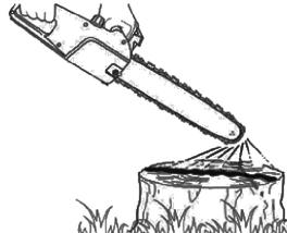
De hoeveelheid kettingolie kan aangepast worden met een schroevendraaier in het gat aan de onderzijde aan de kant van de koppeling. Pas de olietoever aan uw werkzaamheden aan.
