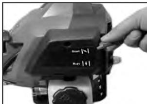
3. Нажать на топливный насос 6 раз.
