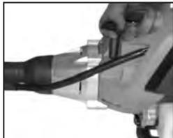
5 Ročico za dovod zraka potisnite v položaj »Run«, nato nežno pritisnite na ročico za plin in potegnite
