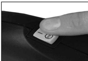
2 Deslice el estrangulador a la posición inicial. Esto no es necesario en caso de un encendido en caliente.
