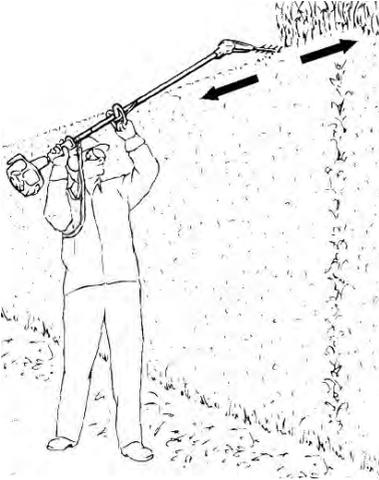
Baş yüksekliği üzerinde hangi pozisyonda çalışılırsa çalışılırsın yorucu olur. Kaza risklerini azaltmak için bu pozisyonda sadece kısa periyotlarla çalışın. Kesici bıçağın açısını maksimuma ayarlayın, böylece makine daha aşağıda tutulabilir ve bu şekilde hala düz bir kesim yapılabilirken daha az yorulunur.
