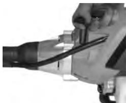
5 Placez le levier de choke du clapet de démarrage sur RUN, enfoncez légèrement le levier des gaz et tirez encore une fois sur le cordon de démarreur jusqu'au démarrage du moteur. Pour pouvoir enfoncer le levier des gaz (1), vous devez auparavant appuyer sur le verrouillage du levier des gaz (2).
