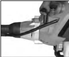
5 Csúsztassa teljesen a RUN pozícióba, enyhén nyomja a gázt és húzza be az indítókótelet, amíg a motor elindul. A gáz adagoló (1) benyomásához először nyomja meg a biztonsági kart (2).
