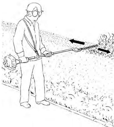
I lavori sopra alla testa sono stancanti e dovrebbero essere eseguiti per brevi periodi anche per questioni di sicurezza. Inclinare il più possibile la barra di taglio. Utilizzare inoltre l'attrezzo servendosi della tracolla per lavorare nel modo meno stancante possibile.
