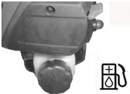
Vooraleer u de tank vult, reinig de ruimte omheen de tankdop, zodat geen vuil in de tank komt.
