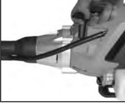
5 Marş motorunu çalışma (RUN) konumuna getirin, tetiğe hafifçe basın starter ipini motor çalışmaya başlayana kadar tekrar çekin.
