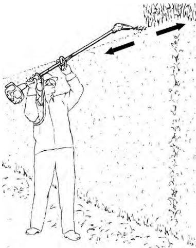
Über Kopfhöhe arbeiten ist ermüdend und sollte auch aus Gründen der Arbeitssicherheit nur kurzzeitig angewendet werden. Den Messerbalken so stark wie möglich abwinkeln. Zusätzlich sollte das Gerät mit Tragegurt verwendet werden um möglichst ermüdungsfrei zu Arbeiten.
