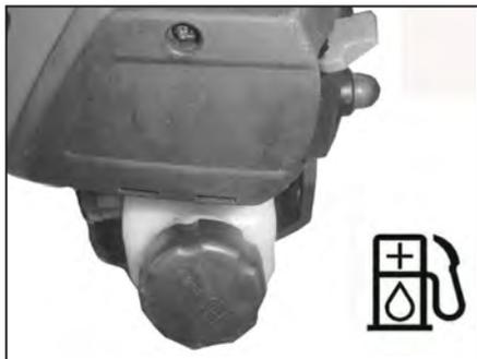
Prije dolijevanja očistite čep spremnika za gorivo i kućište oko njega da biste spriječili ulaženje prljavštine u spremnik.
