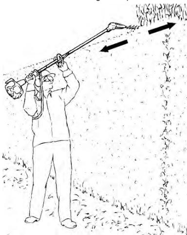
Tout travail au-dessus de la hauteur de tête est fatigant et doit uniquement avoir lieu à court terme pour la sécurité du travail. Couder le plus possible la barre de coupe. De plus, l'appareil doit être utilisé avec la sangle de transport pour travailler en fournissant le moins d'efforts possible.
