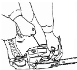
5. Drücken Sie den Knopf der Ansaugpumpe (4) kontinuierlich, bis Kraftstoff kommt.
