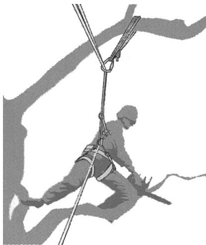
*Esempio di cambiamento di direzione della fune principale tramite un punto di ancoraggio supplementare*
