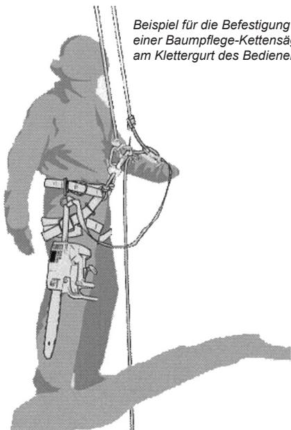
Beispiel für die Befestigung einer Baumpflege-Kettensäge am Klettergurt des Bedieners
