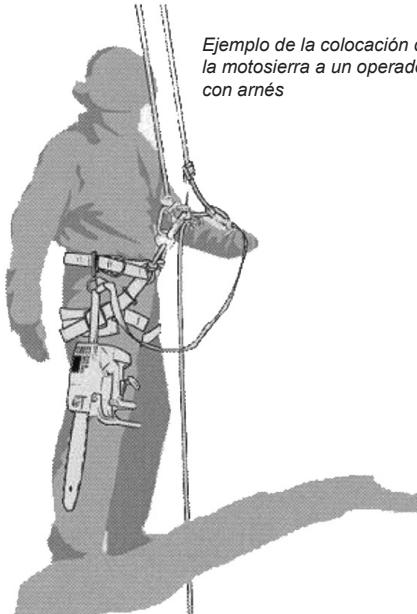
*Ejemplo de la colocación de la motosierra a un operador con arnés*
