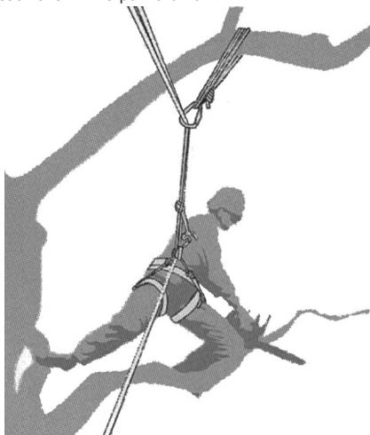
Beispiel einer Umleitung der Hauptsicherung über einen zusätzlichen Ankerpunkt
