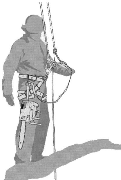
Esempio di attacco della sega a catena per la manutenzione degli alberi all'imbracatura a cinghia dell'operatore
