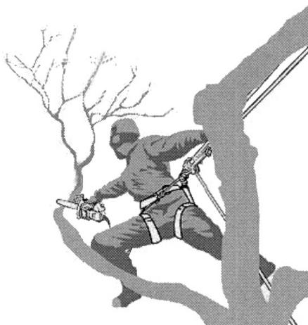
*Beispiel einer einhändigen Nutzung der Kettensäge*
